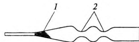
Рис.2. Трубка Эмиха: 1 – асбестовое волокно, пропитанное перегоняемой жидкостью; 2 – сужение
